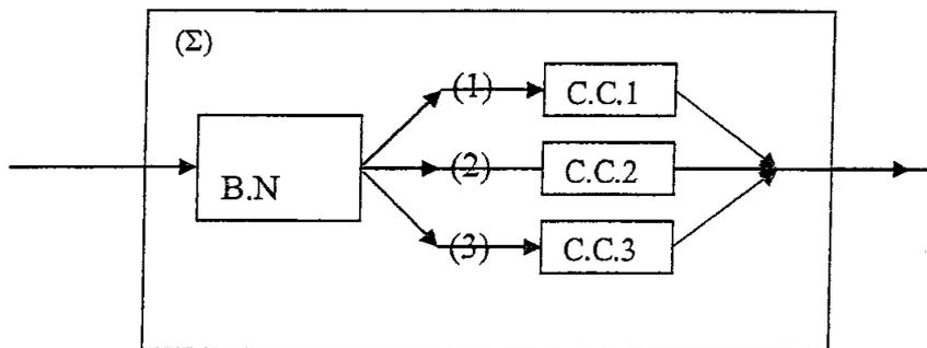
Un système  $(\Sigma)$  est composé d'une boîte noire (B.N) où un signal entrant  $(E)$  est dirigé aléatoirement sur un seul canal (1), (2) ou (3). Sur chacun de ces canaux se trouve un coupe-circuit aléatoire (C.C.I).
